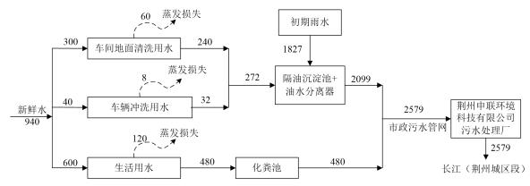
图 3-5 项目水平衡图 单位: m³/a
