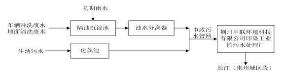
图 7-3 本项目污水处理工艺图
