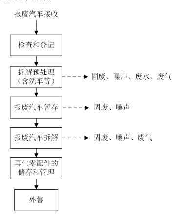
图 3-2 报废汽车拆解总工艺流程图
