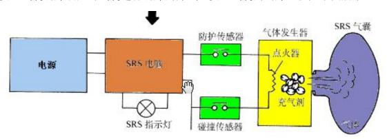
图 3-3 项目安全气囊引爆过程示意图
