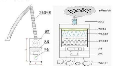
图 7-1 移动式烟尘净化器过滤净化原理示意图
