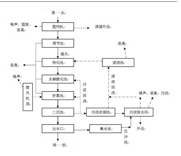
图 7-7 申联公司污水处理厂设计工艺流程示意图
