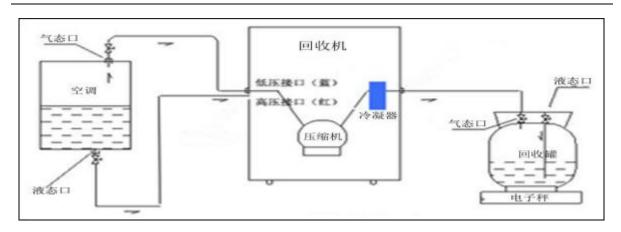
图 7-2 冷媒回收装置回收管路连接示意图
