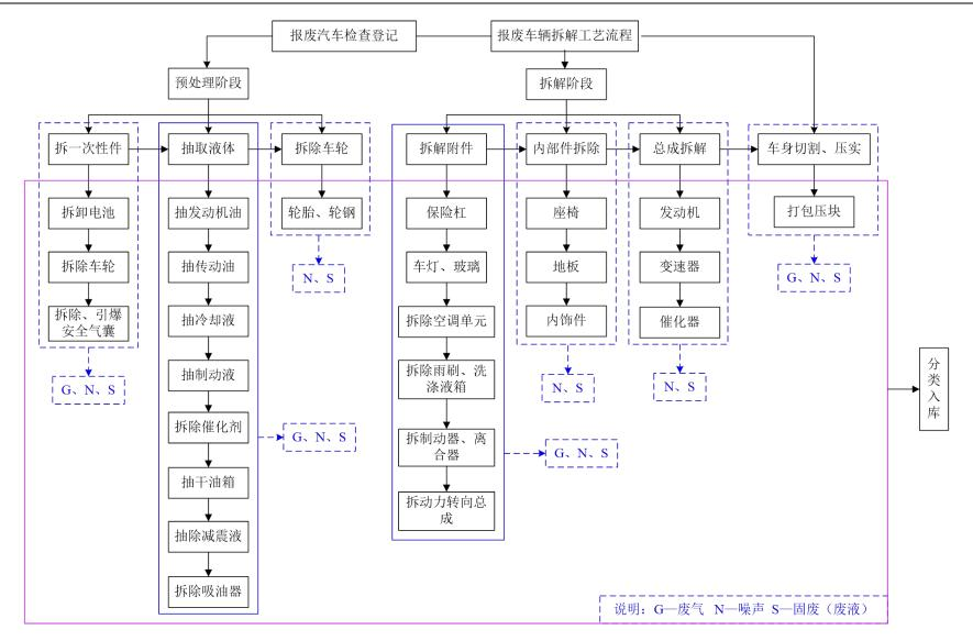
图 3-1 报废汽车拆解工艺流程及产污环节示意图
