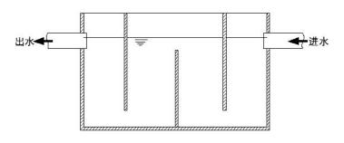
图 7-5 隔油沉淀池原理图
