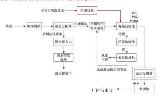
图 7-4 本项目清洗废水及初期雨水处理工艺流程图
