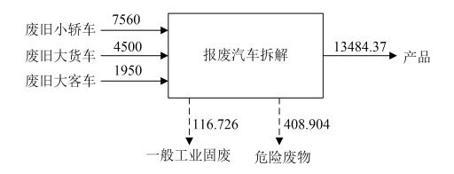
图 3-4 报废汽车拆解过程物料平衡图 单位: t/a
